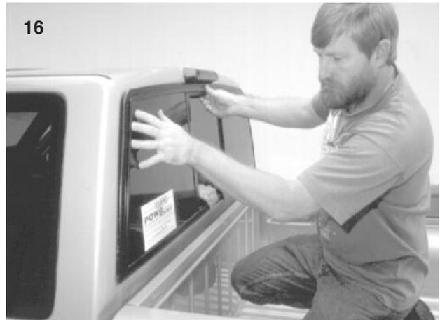
Während Ihr Mitarbeiter den Tri-Ventrahmen von der Außenseite drückt, drücken Sie mit den Schlitz-Schraubenzieher die Clips über die Pinchwelt Lippen in Position. Siehe Foto 18. Diese Laschen sichern den Tri-Vent, während der Dichtstoff härtet und ermöglicht den Wagen sofort nach der Installation gefahren zu werden.
