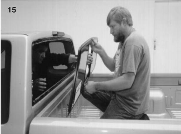
Heben Sie vorsichtig das Tri-Vent Fenster und setzen es in die Kabinenöffnung. Siehe Foto 15.
