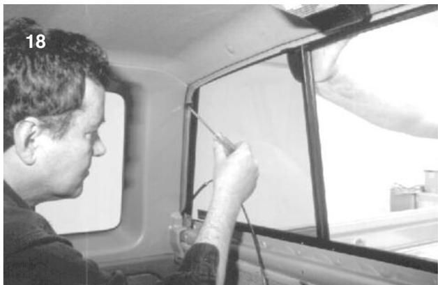
Installieren Sie die schwarze Kunststoff-Zierleiste um die Fensteröffnung an der Innenseite der Kabine. Haken Sie das innere Bein über die Lippe der Pinchweld und pressen es in Position. Wo immer die Zierleiste über die umgebogenen Teile gehen, kerben Sie vorsichtig einen Spielraum nach Bedarf aus. Installieren Sie über die untere Seite, die Versiegelungskante für korrekte Ausrichtung. Siehe Foto 20.
