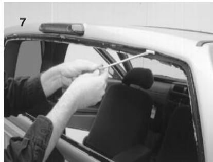
Setzen Sie das Tri-Vent Schiebefenster in die Kabinenöffnung und überprüfen eine bündige Anpassung. Jede Justierung der Fensteranpassung oder Biegung sollte, bevor der Dichtstoff angewendet wird, erfolgen. Siehe Foto 8. Beachten Sie das Licht auf der Kabinenaußenseite oberhalb der Heckscheiben Öffnung. Wenn es mit der Installation stört, entfernen Sie es und legen es beiseite.
