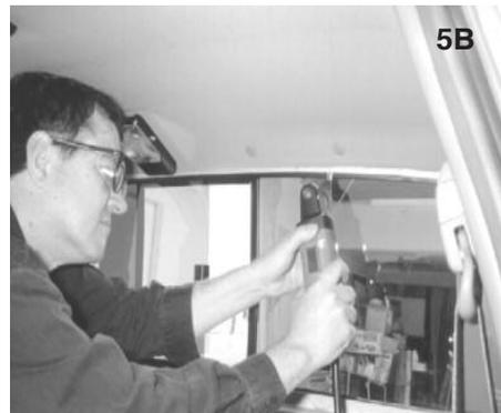
Verwenden Sie CRL Wildcat Urethan Schwingmesser und CRL Wildcat Klinge und schneiden das Heckfenster von der Innenseite der Kabine aus. Platzieren Sie eine Schutzabdeckung über die Ladefläche und decken die Sitze mit Plastikfolie ab. Siehe Foto 5A und 5B und Diagramm 5C
