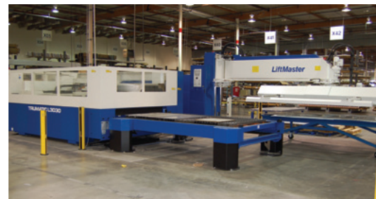
Trumatic L3030 CO 2 Laser Trumatic L3030 CO 2 Laserschneidanlage
