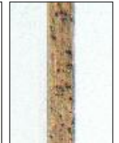
Diamond Metal Bond Edge of NS3B Blade
